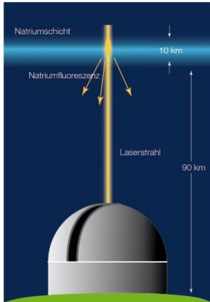
ABB. 5: Zur Vermeidung von Parallaxe wird ein Laserstrahl von einem kleinen Teleskop in der Nähe des Hauptteleskops in die Atmosphäre „gelauncht“. Die resonante Wechselwirkung mit dem Natrium der Mesosphäre erzeugt einen künstlichen, punktförmigen Stern, der als Referenzobjekt für die adaptive Optik genutzt wird.
